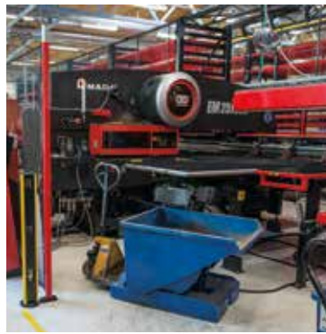
Klaukkalan tehtaan kolme vuotta sitten uusittu FMS-järjestelmä on servokäyttöinen, säästää oleellisesti energiaa, eikä tarvitse hydrauliöljyä.
